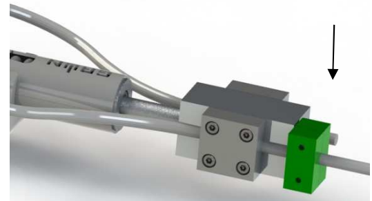
Abb. 2: Sichtkontrolle Indikatorcklemme Sollzustand: Grüne Klemme hat max. 2mm Spalt
