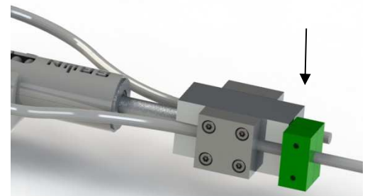
Abb. 2: Sichtkontrolle Indikatorklemme Sollzustand: Grüne Klemme hat max. 2mm Spalt
