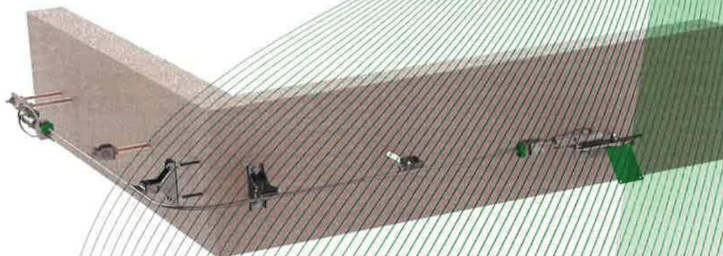
Bild 2: Anschlagseinrichtung Typ C, Typ: Greenline GES-3, Montagebeispiel Fassade Drahtseilsystem mit Kurven überfahrbar
