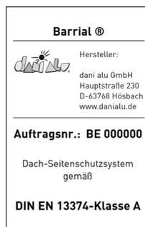
Der Barrial Materiallieferung liegt ein Prüfetikett mit der aktuellen Objekt-Nummer bei. Dieses ist nach Abschluss der Montage im Bereich des Zuganges zum Seitenschutz unbedingt seitlich an einer Geländerstütze gut sichtbar zu befestigen. (Alle Prüfetiketten können bei Bedarf bei dani alu GmbH nachbestellt werden.)
