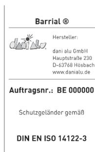
Der Barrial Materiallieferung liegt ein Prüfetikett mit der aktuellen Objekt-Nummer bei. Dieses ist nach Abschluss der Montage im Bereich des Zuganges zum Geländer unbedingt seitlich an einer Geländerstütze gut sichtbar zu befestigen. (Alle Prüfetiketten können bei Bedarf bei dani alu GmbH nachbestellt werden.)
