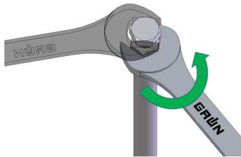
Zum Lösen der Einbauhilfe M16 unbedingt 2 Stück Maulschlüssel verwenden!
